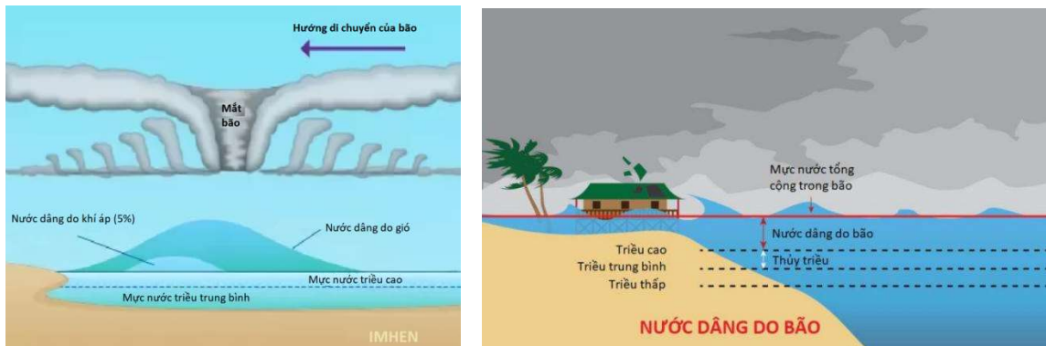
Hình 2. Các thành phần đóng góp vào nước dâng do bão (gió và áp suất khí quyển) - Mức nước thủy triều, nước biển dâng do bão hợp thành mức nước tổng cộng do ảnh hưởng bão ngoài biển cao hơn bình thường làm chậm thoát lũ ra biển.
